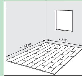
6 En cas de pièces de plus de 12 m de longueur et de plus de 8 m de largeur, un joint de dilatation intermédiaire doit être placé. La dilatation et la contraction sont linéaires ; par conséquent, plus la surface est grande, plus le joint de dilatation doit être grand. Un joint de dilatation doit être généralement utilisé aux entrées et aux angles de la pièce. Les parquets ne sont pas adaptés aux pièces humides telles que les salles de bains et les saunas.
