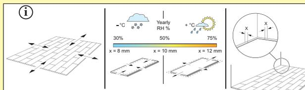
L'espace doit rester ouvert et ne doit pas être rempli avec du mastic, du silicone ou tout autre adhésif. Une pose flottante est une pose flottante, alors ne fixez jamais le sol avec des clous, de la colle, des vis, ou tout autre moyen.
