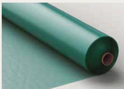
FILM PE (POLYÉTHYLÈNE) 12,5 × 2,7 m = 33,75 m 2 /rouleau. Protège le sol de la vapeur d'eau provenant d'un support minéral ou en béton. Durée de vie utile de 50 ans. Épaisseur : 0,2 mm.
