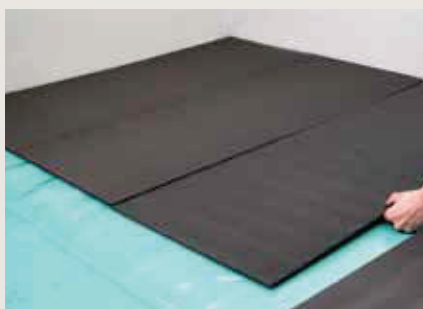
PANNEAUX ISOLANTS QUICKHEAT Panneaux isolants. 120 × 50 × 0,7 cm. 10 panneaux/lot. 0,6 m 2 /panneaux, 6 m 2 /lot. Épaisseur : 7 mm. Il est recommandé d'utiliser un pare-vapeur. Posez le film PE (PGUDLSCREEN34) sous les panneaux d'isolation QuickHeat et sur les éléments chauffants QuickHeat.
