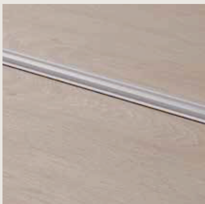
PROFILÉ COMBI, COULEUR ARGENT 1860 x 47 x 16 mm Le profilé combi Pergo peut niveler les différences de hauteur, pour une transition en douceur vers tout autre type de sol. Convient aux différences de niveau de 0 à 12,3 mm. Surface : aluminium. PGPRSILV
