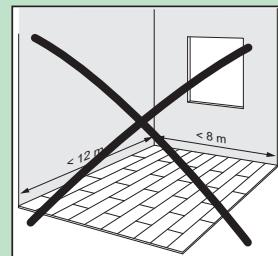
**6** Lors d'une pose par collage, vous n'êtes pas soumis à des restrictions de longueur et de largeur. Un écart de dilatation autour du périmètre de la pièce reste obligatoire, mais l'utilisation d'un profilé aux entrées n'est plus nécessaire.
